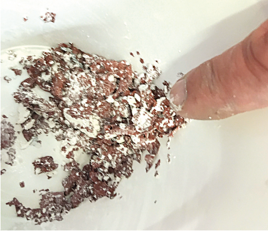
Abb. 2 // Abgereinigte Kontamination in einer Fertigwarenleitung für Dispersionsfarben.
